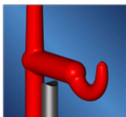
Stützauswerfer konturieren Contouring of a supporting ejector
