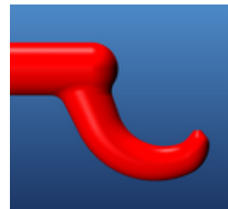
Optimale Anguss-Geometrie, gut verrundet
