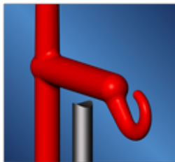
Stützauswerfer konturieren Contouring of a supporting ejector
