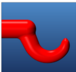
Optimale Anguss-Geometrie, gut verrundet
