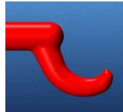
Optimale Anguss-Geometrie, gut verrundet
