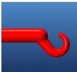
Optimale Anguss-Geometrie, gut verrundet
