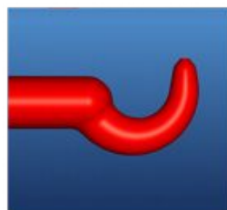
Optimale Anguss-Geometrie, gut verrundet
