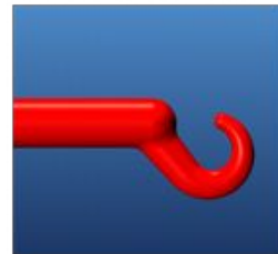
Optimale Anguss-Geometrie, gut verrundet
