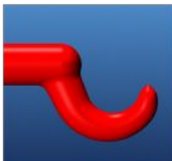
Optimale Anguss-Geometrie, gut verrundet
