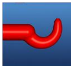
Optimale Anguss-Geometrie, gut verrundet
