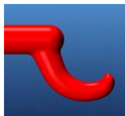
Optimale Anguss-Geometrie, gut verrundet
