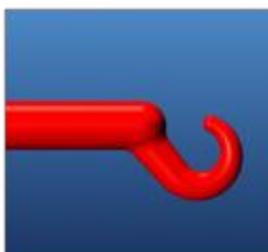
Optimale Anguss-Geometrie, gut verrundet
