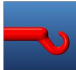
Optimale Anguss-Geometrie, gut verrundet
