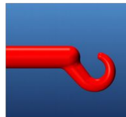
Optimale Anguss-Geometrie, gut verrundet
