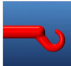
Optimale Anguss-Geometrie, gut verrundet
