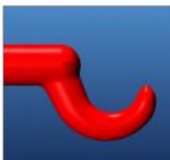
Optimale Anguss-Geometrie, gut verrundet
