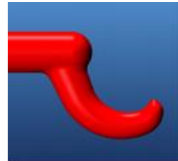
Optimale Anguss-Geometrie, gut verrundet
