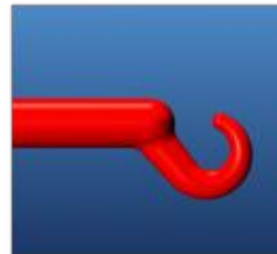
Optimale Anguss-Geometrie, gut verrundet
