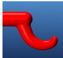
Optimale Anguss-Geometrie, gut verrundet
