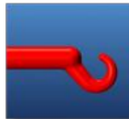
Optimale Anguss-Geometrie, gut verrundet
