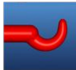
Optimale Anguss-Geometrie, gut verrundet
