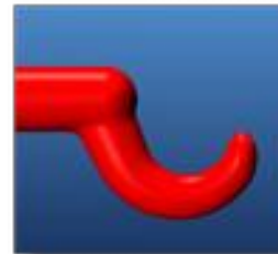
Optimale Anguss-Geometrie, gut verrundet
