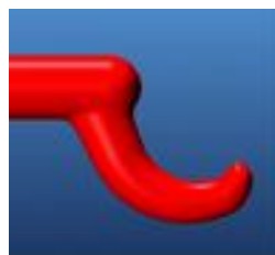
Optimale Anguss-Geometrie, gut verrundet
