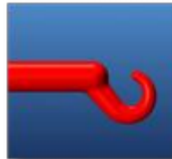
Optimale Anguss-Geometrie, gut verrundet
